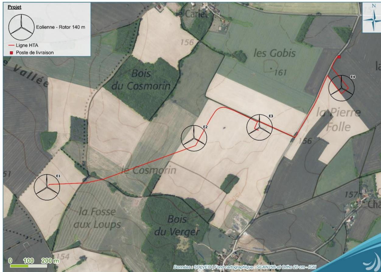
Figure 42 : Raccordement interne du parc éolien
