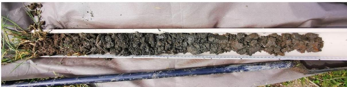
Figure 12 : Exemple de sondage s3 et horizons réductiques
