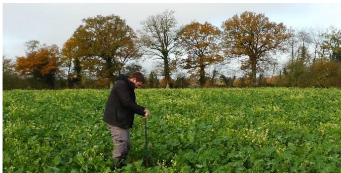
Prélèvement à l'aide d'une tarière pédologique © Calidris
