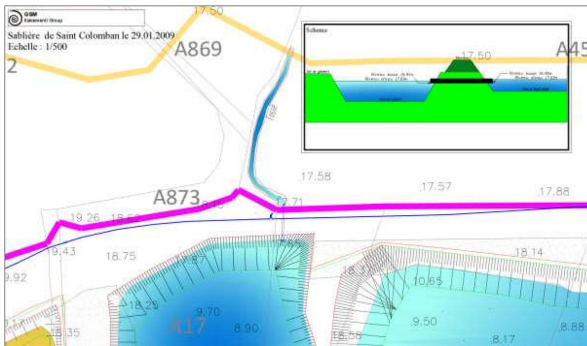
Figure 9 : Schéma et relevé de niveau du trop plein de la carrière de la Grande Garde du 29/01/2009 (GSM)
