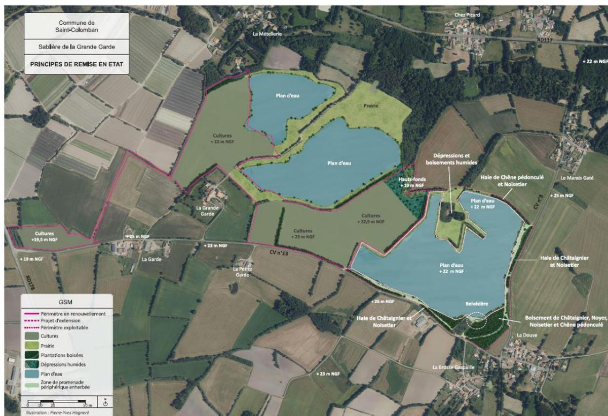
Figure 20 : Principes de remise en état du site (source : GSM)
