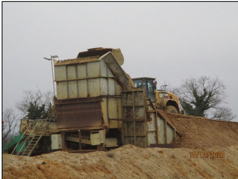
Figure 27. Photographie de la trémie d'alimentation des bandes transporteuses par la chargeuse à proximité de la zone d'extraction
