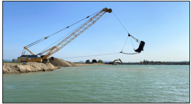
Figure 25. Pelle à long bras (à gauche) et dragueline (à droite)
