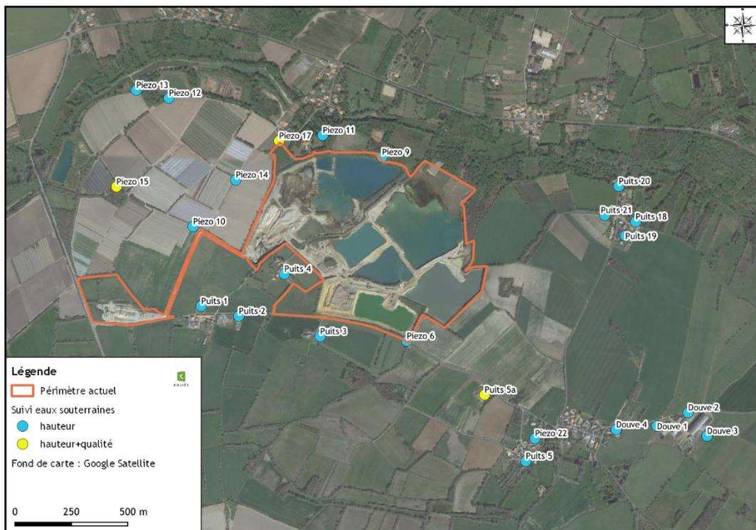
Comme le montre la carte au chapitre IV.3.4.2 de la pièce 6.2 Etude d'impact, reprise ci-dessous, le suivi des eaux souterraines sera poursuivi au niveau des piézomètres et des puits, que ce soit pour la qualité comme pour le niveau de la nappe. Un puits (Douze 4) et trois piézomètres (Piézo 15, 17 et 22) de suivi seront ajoutés au suivi actuel.
