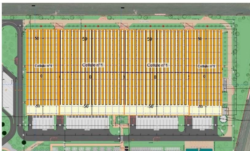
Figure 9 - Plan de racking du bâtiment
