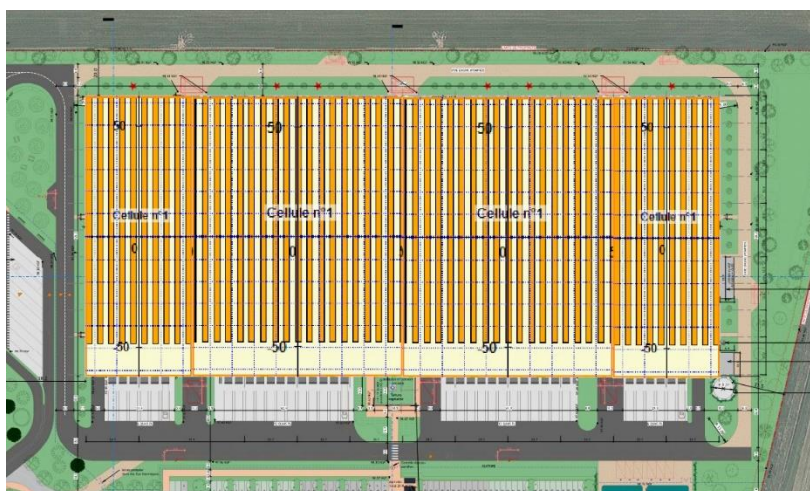
Figure 9 - Plan de rackage du bâtiment
