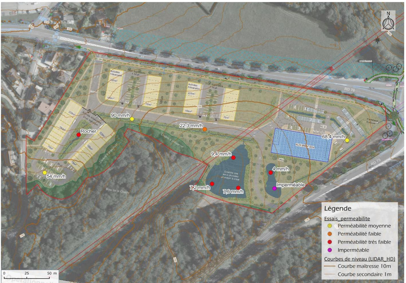
Figure 11 : Localisation des essais de perméabilité (source : Compétence Géotechnique)
