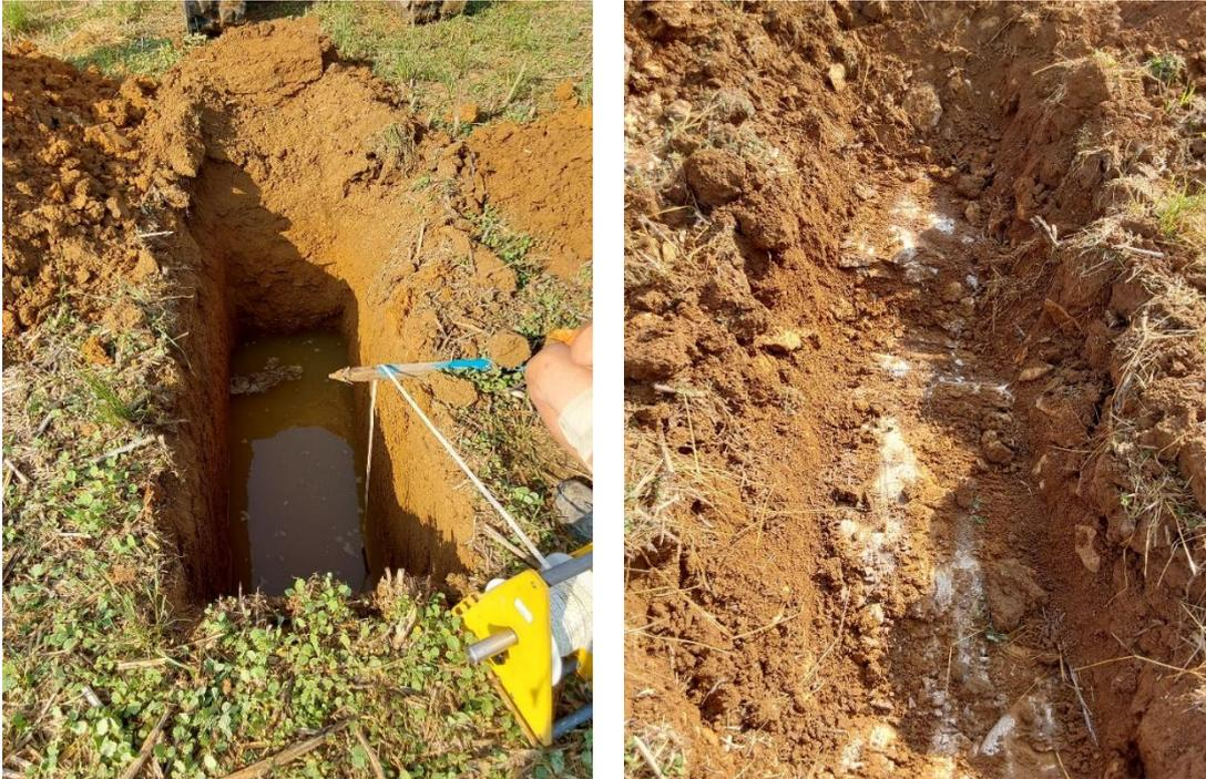
Figure 10 : Photographies des tranchées : A gauche : Limon argileux – A droite : Dalles rocheuses calcaire
