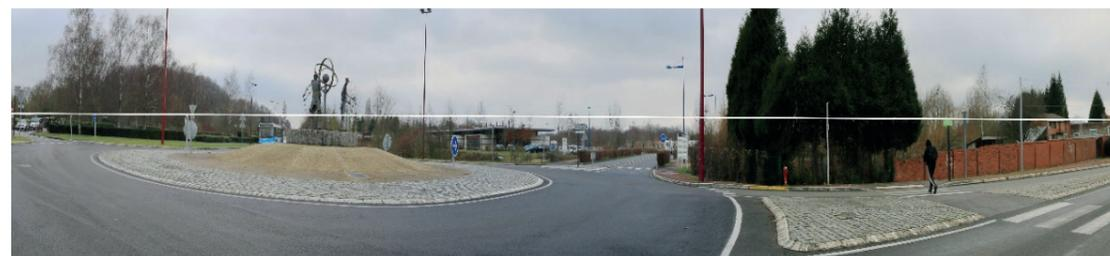
Exemple d'horizon concave lié à une mauvaise mise à niveau de l'appareil (Le trait blanc est le niveau de référence)
