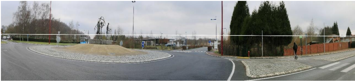
Horizon concave lié à une mauvaise mise à niveau de l'appareil (Le trait blanc est le niveau de référence)
