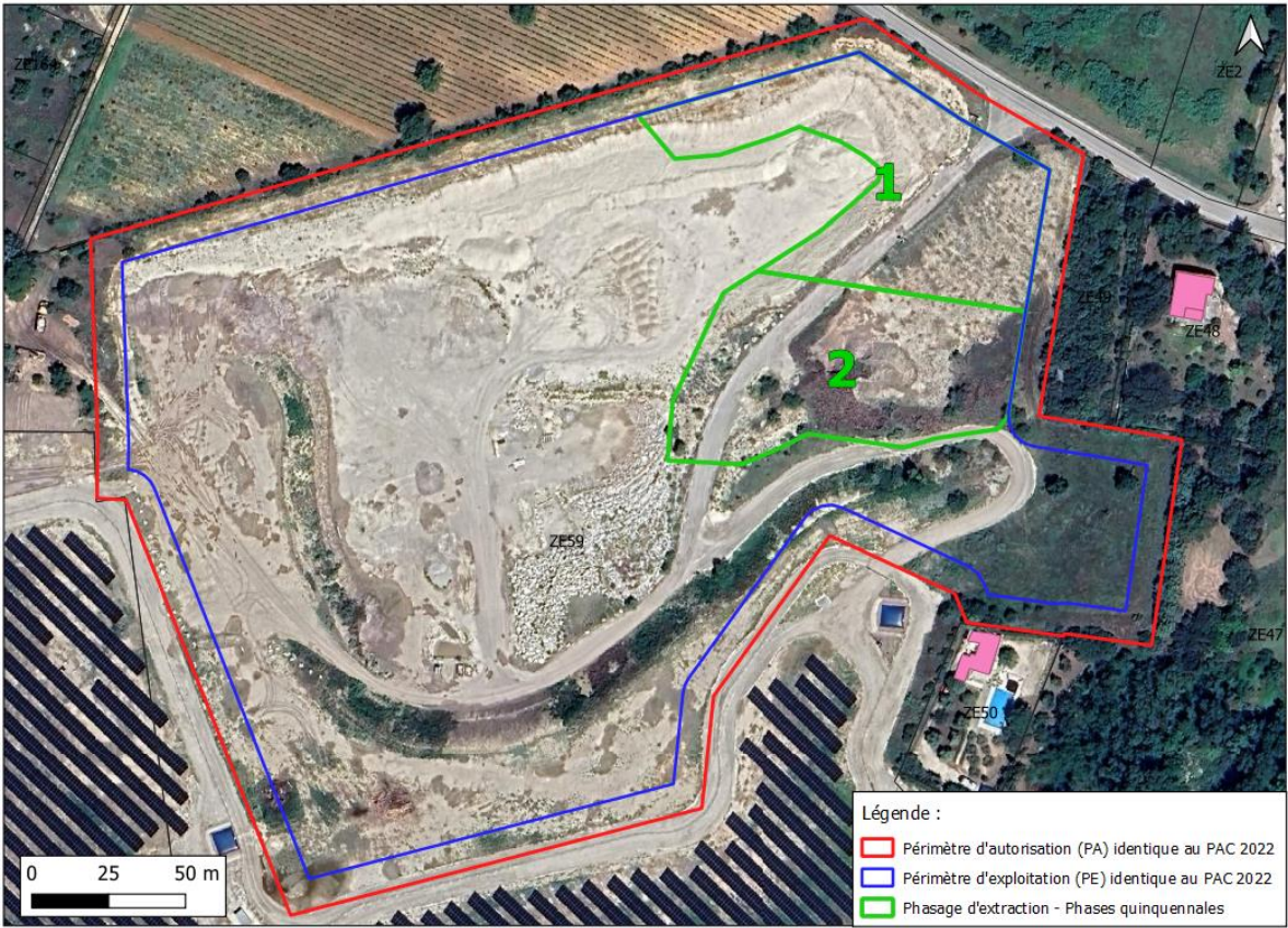
Figure 2. Plan de phasage de l'exploitation – Phases quinquennales d'extraction
