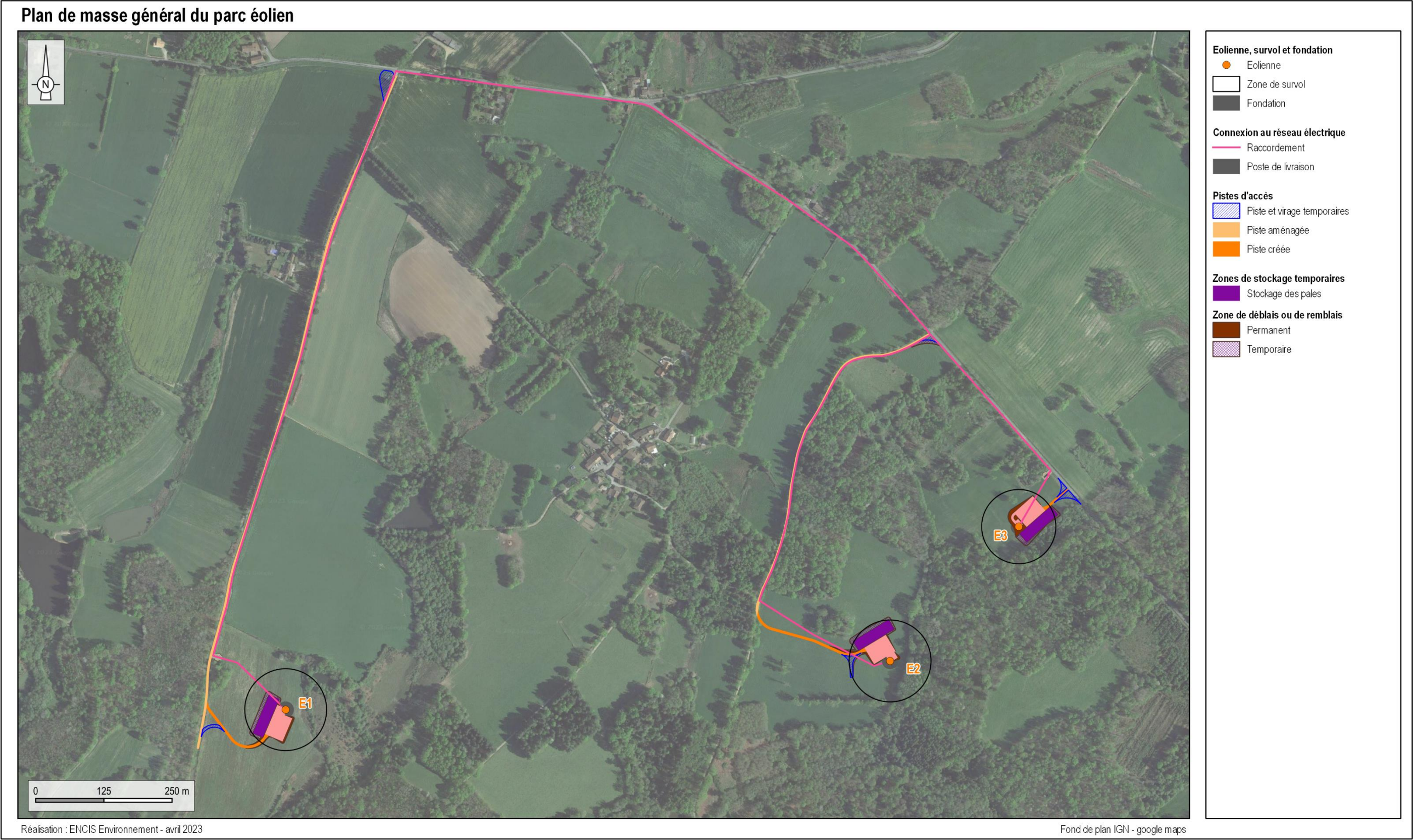
Carte 6 : Plan du projet de parc éolien des Moulins de l'eau plaidée (Source : Étude d'impact du projet de parc éolien des Moulins de l'eau plaidée)
