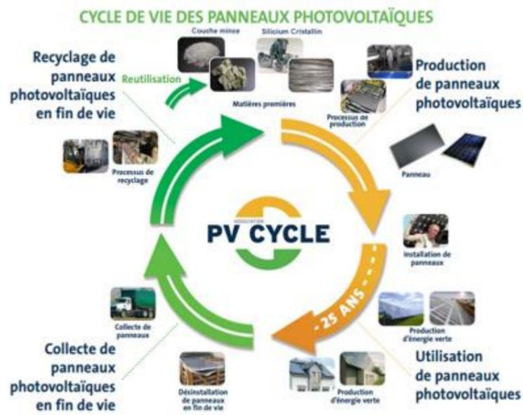
Figure 86 : Le cycle de vie des panneaux photovoltaïques
