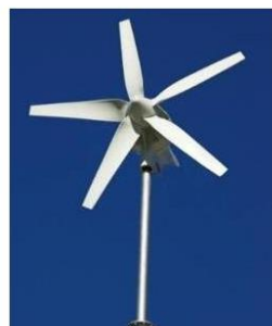
Figure 16. Petit éolien à axe horizontal
