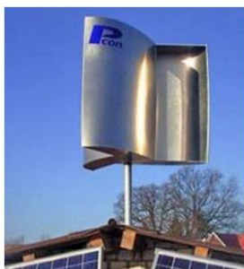
Figure 15. Petit éolien à axe vertical
