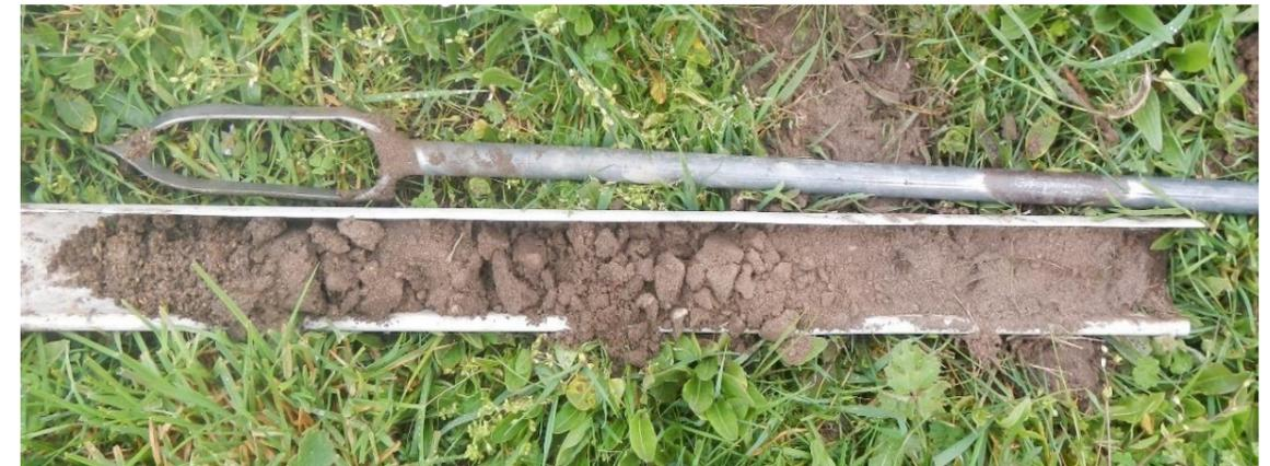
Photo 15 : Le sondage numéro 6 sur une profondeur de 80 cm
