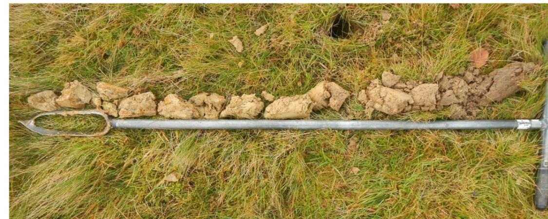
Photo 1 : Exemple de carottage sur une profondeur de 120 cm (Source : AEPE Gingko)
