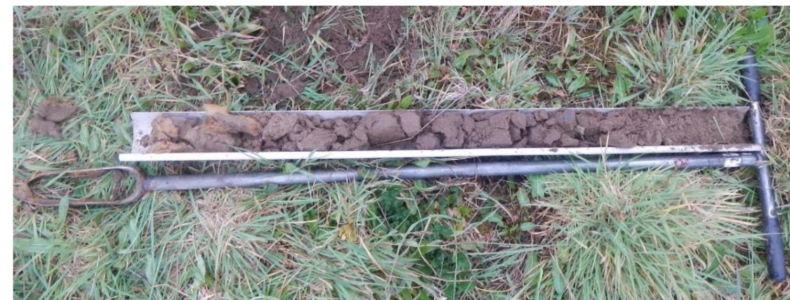
Photo 10 : Le sondage numéro 1 sur une profondeur de 100 cm
