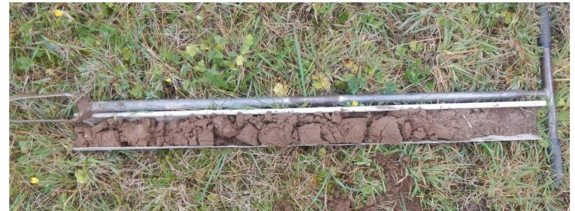
Photo 16 : Le sondage numéro 7 sur une profondeur de 100 cm
