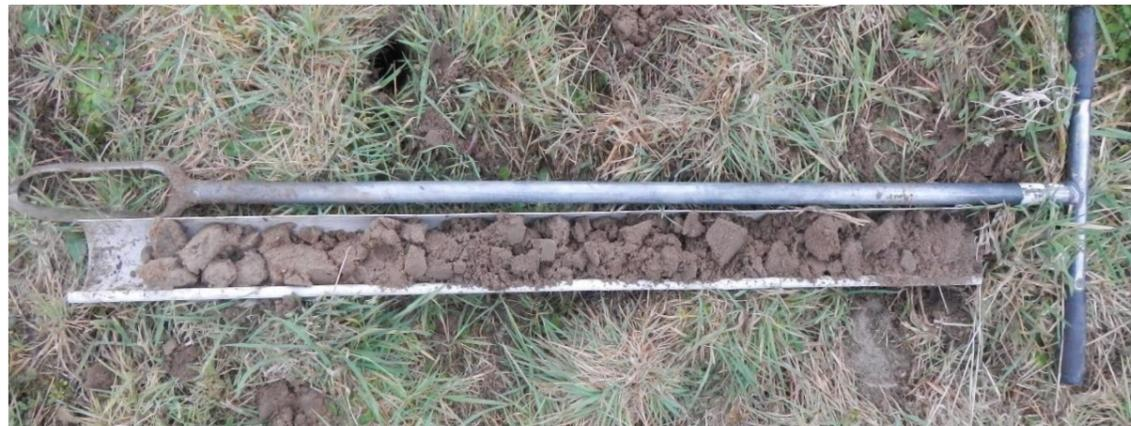
Photo 13 : Le sondage numéro 4 sur une profondeur de 95 cm
