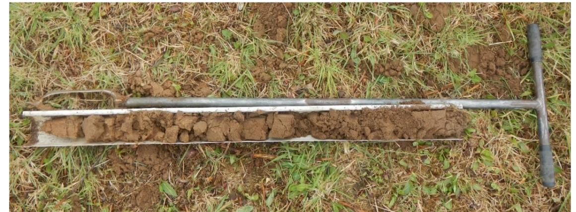
Photo 20 : Le sondage numéro 11 sur une profondeur de 100 cm
