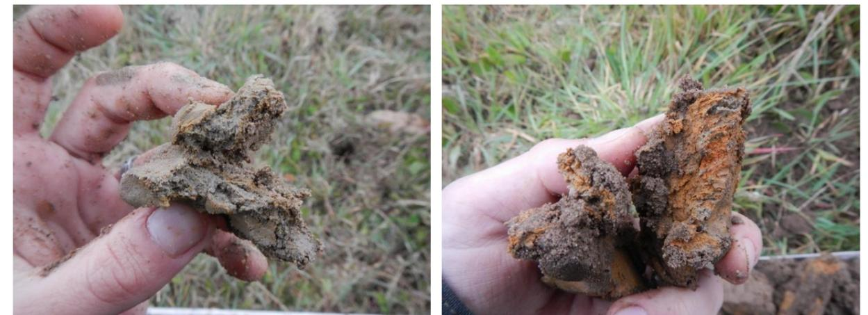
Photos 23 et 24 : Horizon hydromorphe limono-argileux observé en profondeur
