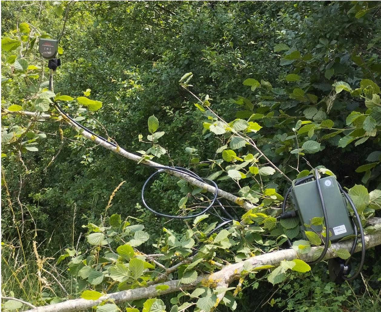
Figure 7 : Pose du SM4 pour les inventaires acoustiques au sol (Source : M. Baloge)
