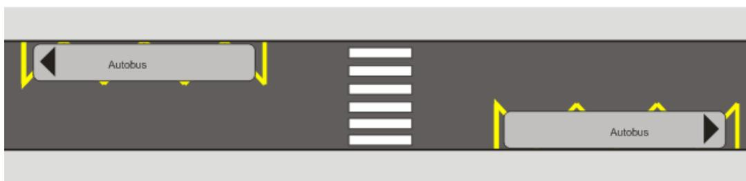
Le passage piéton doit être placé à 10 m derrière l'arrêt (minimum 5 m) et à 10 m minimum devant l'arrêt. En effet, cela permet de conserver une distance acceptable entre le point d'arrêt et la traversée piétonne, et ainsi éviter que le piéton coupe la chaussée hors du passage matérialisé. Il faut prévoir des barrières en cas d'usage dangereux des piétons.
