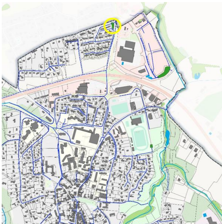
Figure 15 : Localisation du bassin d'orage "lotissement Bellevue"
