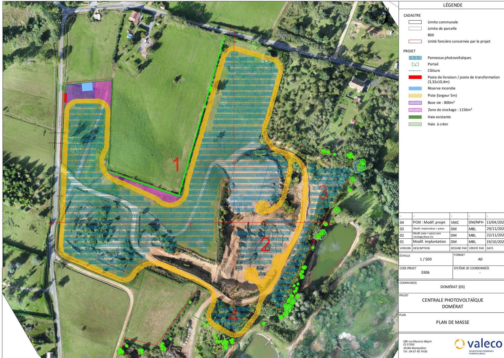
Figure 6 : Plan du projet de parc photovoltaïque sur fond ortho (Source : VALECO)
