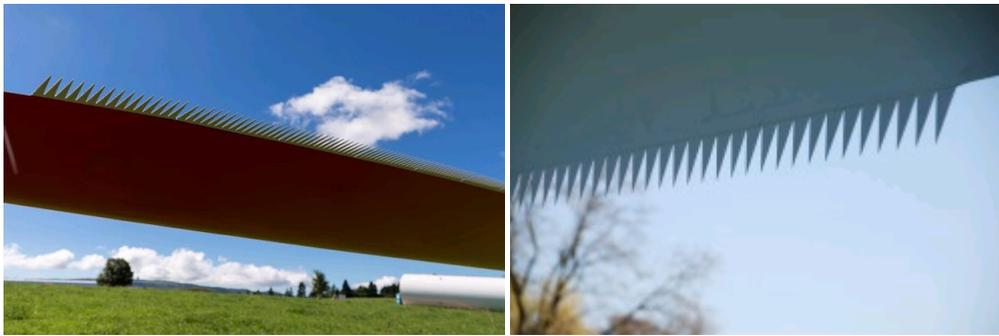
*Photographies d'une pale dotée d'un système TES (peigne / dentelure)*
