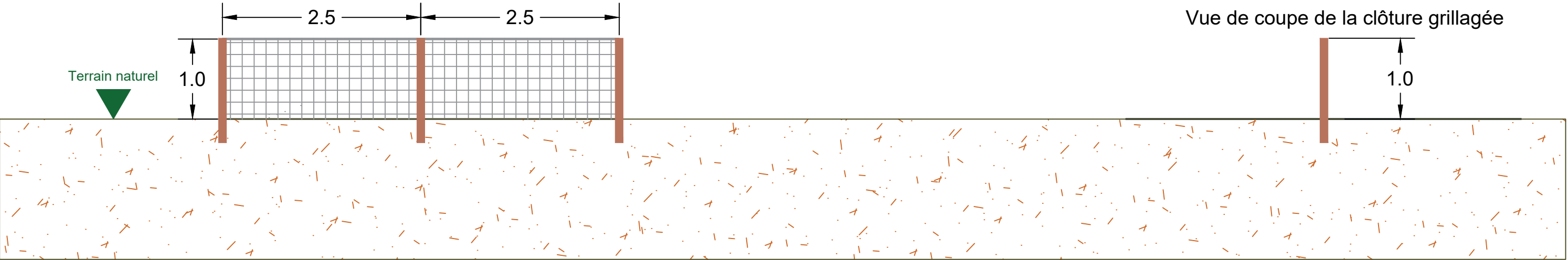
Vue de face de la clôture grillagée Maillage 15cm x 15cm et piquets en bois
