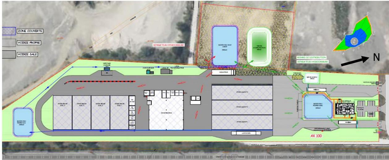
Figure 52 : Réseaux et zones de collecte des eaux de ruissellement du site
