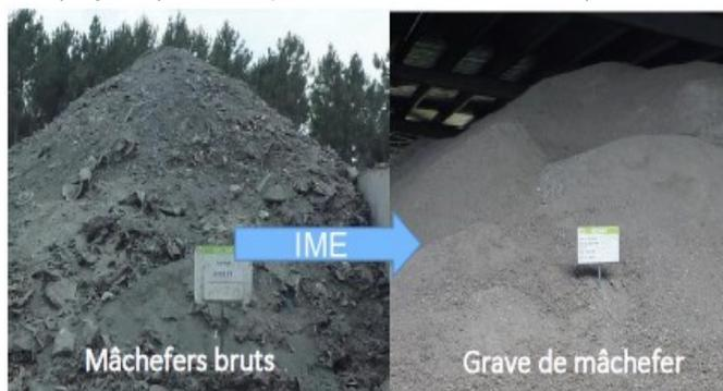
Comme illustré sur la figure 2, l'installation comprendra plusieurs unités mettant en œuvre ces étapes. Après un passage sur le pont bascule, les mâchefers bruts seront déchargés dans des box en béton, d'où ils seront repris pour être traités dans le processus de criblage et de démétallisation. Le produit sera ensuite transporté par chargeuse vers les box de maturation. Après trois mois de maturation, la grave de mâchefer sera expédiée par camions vers les chantiers utilisateurs.
