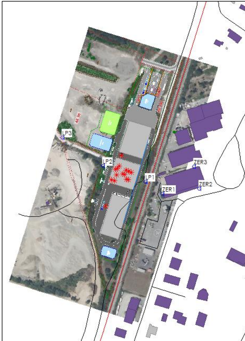
Figure 2. Modélisation de la zone d'étude environnementale (vue en plan) contenant les sources de bruit
