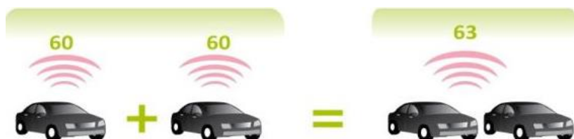
Figure 4 : Doublement de l'intensité sonore (source : EGIS/ACOUSTB)
