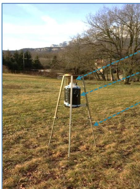
Figure 1 : Installation d'une jauge
