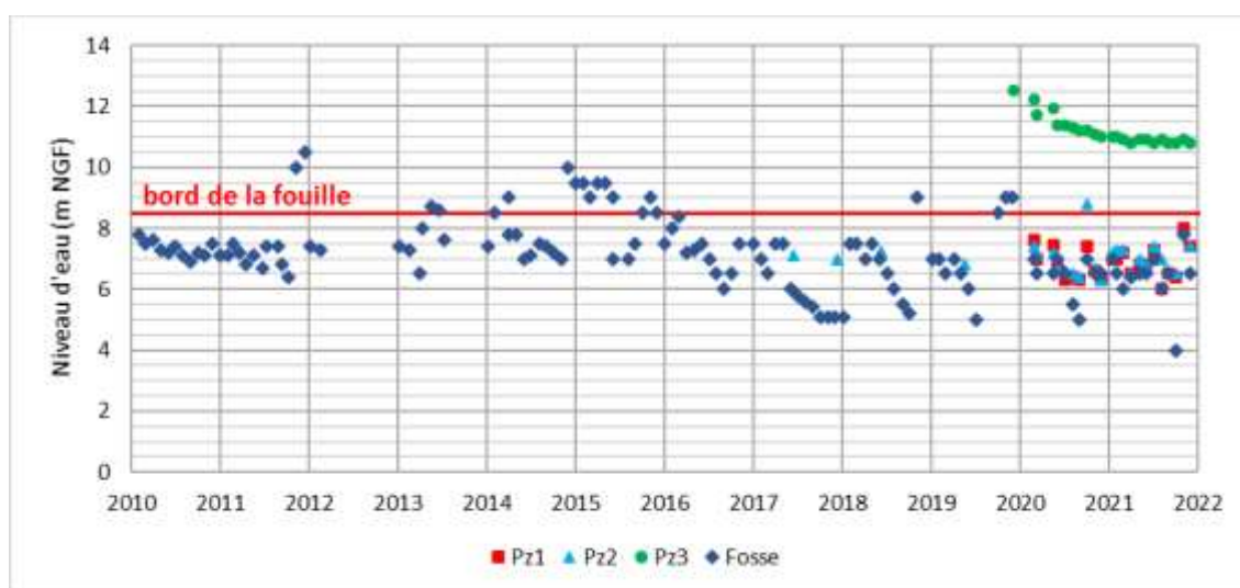
Figure 3 : Piézométrie au niveau de la fosse de la carrière Heidelberg Materials France Ciments Source : BERGA-SUD
