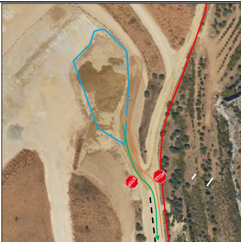
Figure 67 : Circulation au niveau du point de croisement des engins de carrière et des camions
