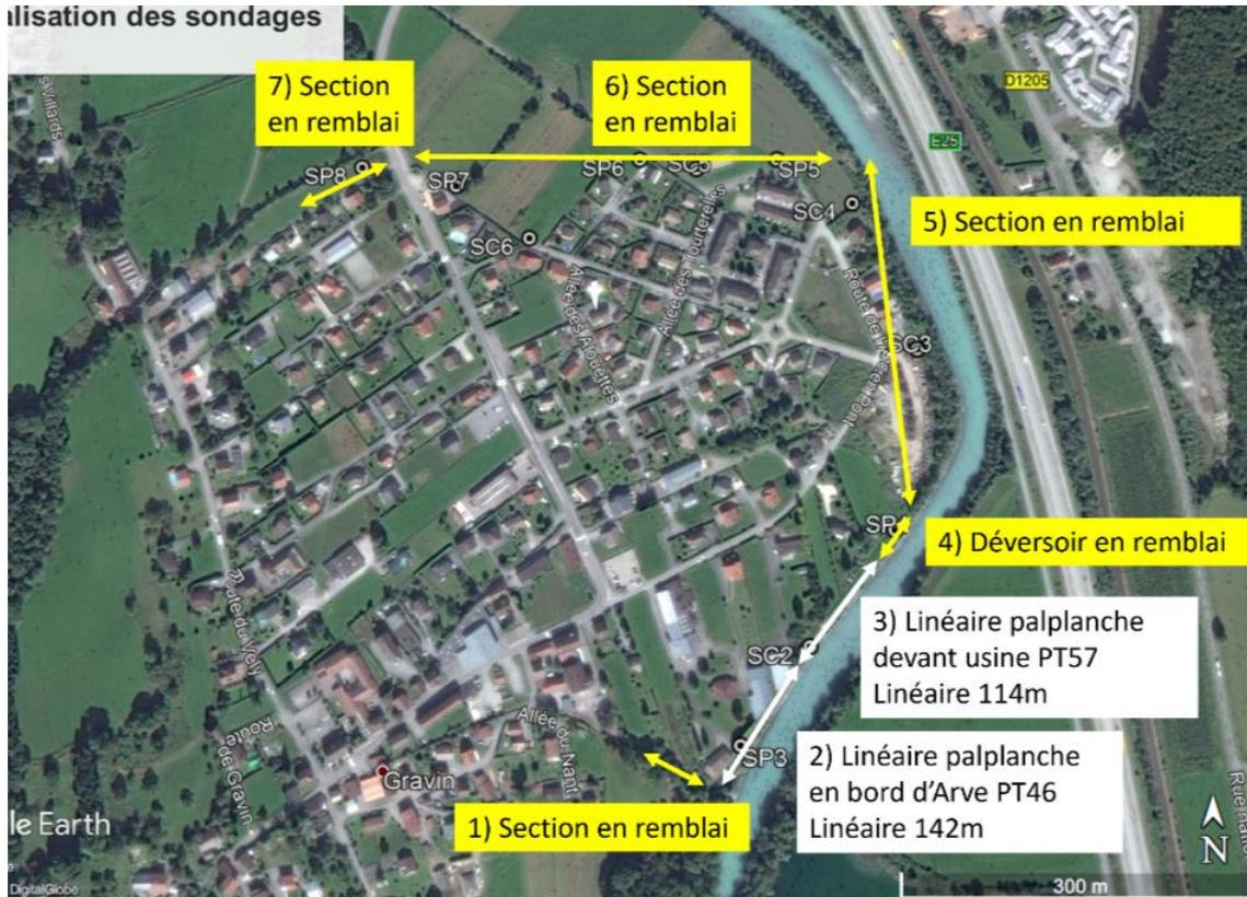
Figure 2 : Vue en plan zone d'Arve – Implantation des palplanches
