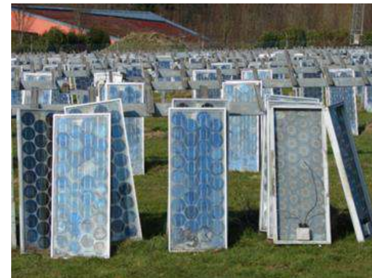
Figure 82 : Panneaux photovoltaïques en fin de vie (source : Soren, 2015)
