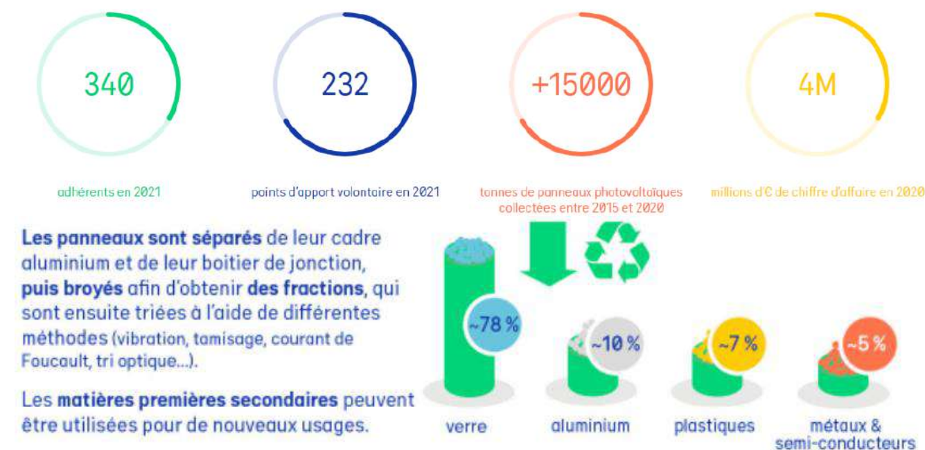
Figure 83 : Le traitement des panneaux photovoltaïques (source : Soren, 2022)
