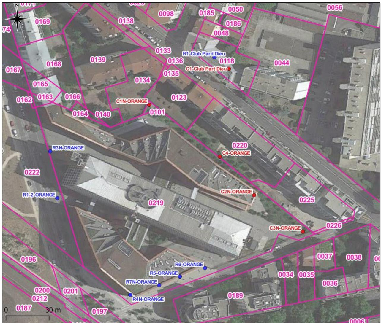
Figure 2 : Implantation des forages de géothermie au droit du site
