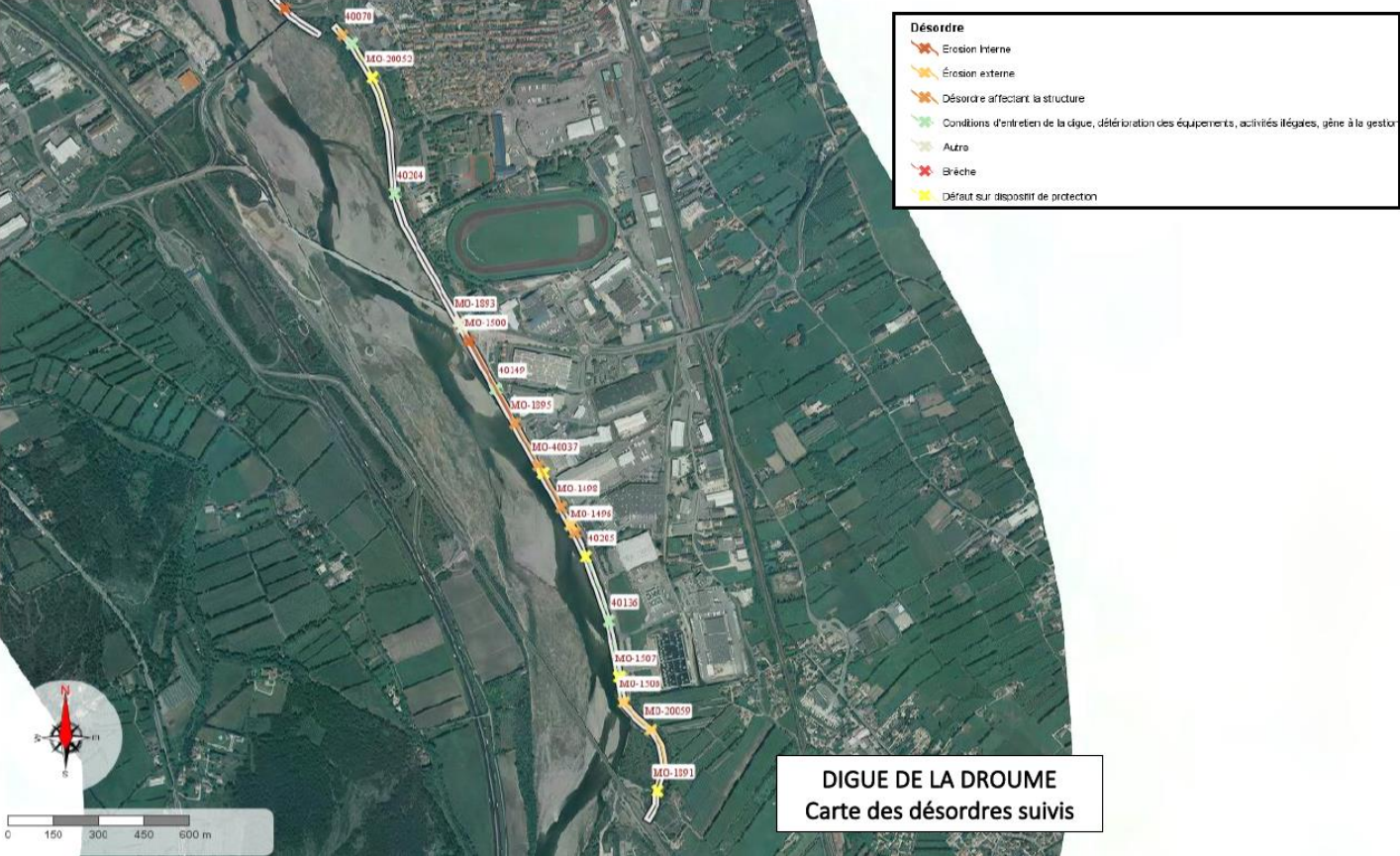
Illustration 8 : Identification des désordres suivis, digue de la Droume – Rapport de visite technique approfondie, SMAVD, 2020
