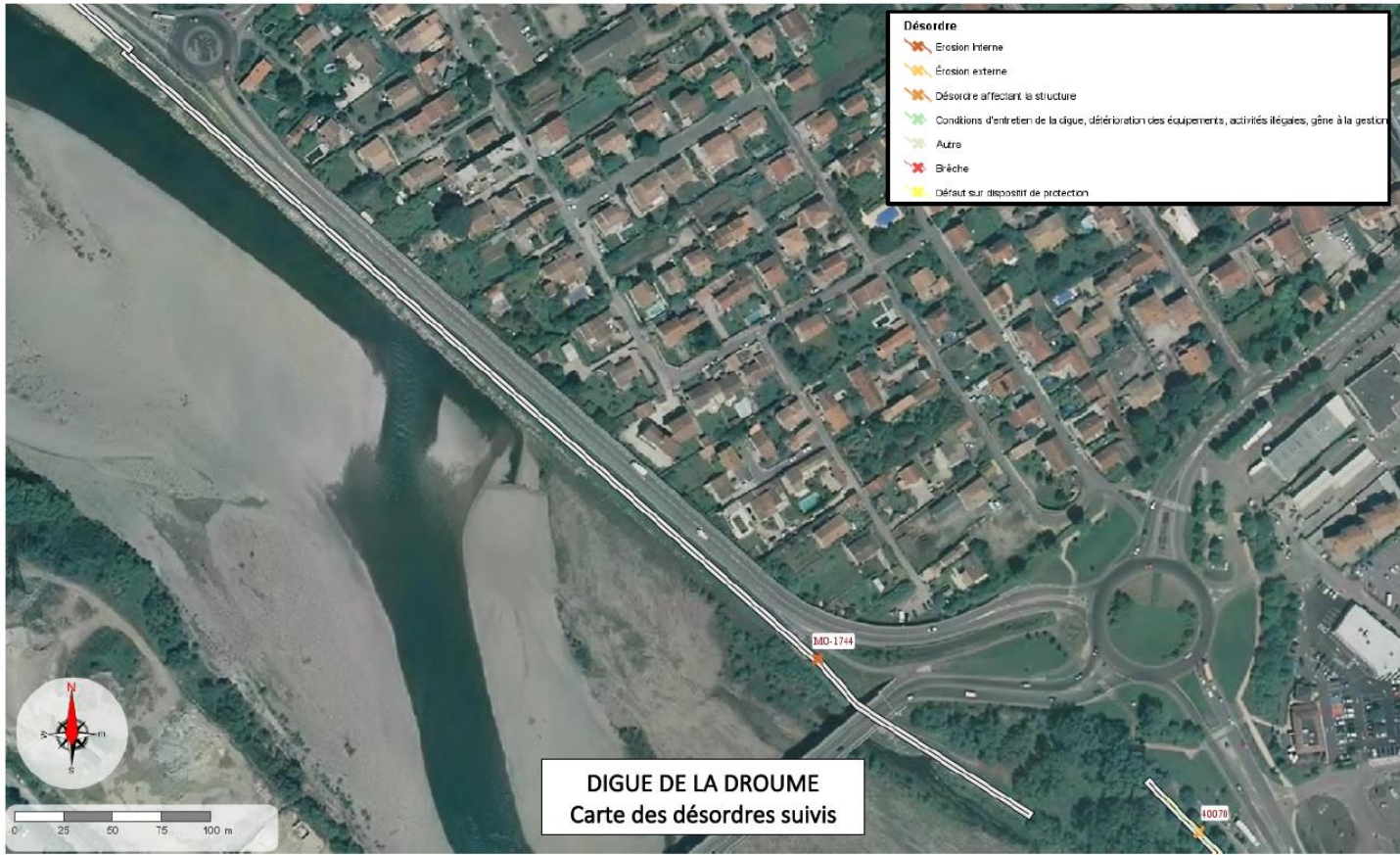
Illustration 11 : Identification des désordres suivis, digue de Sébastiani – Rapport de visite technique approfondie, SMAVD, 2020
