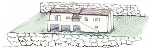
A éviter : soutènement et enrochements trop imposants
