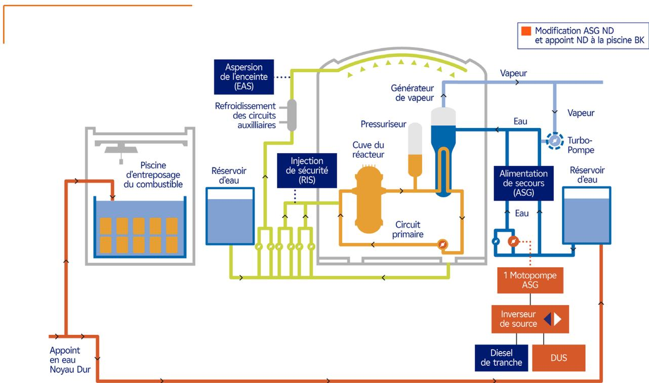
Figure 15. Schéma de principe de la disposition ASG-ND et appoint Noyau Dur aux piscines BR et BK
