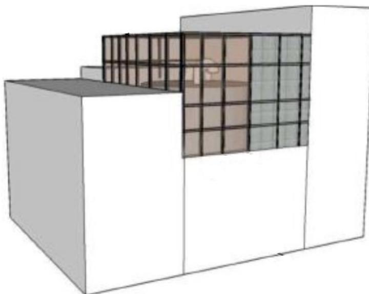
Figure 19. Protection contre la tornade « Noyau Dur » : photo de l'installation actuelle – exemple du réacteur n° 1 du CNPE du tricastin – et illustration de la disposition proposée, de type « grilles renforcées », autour de la bache PTR cylindrique.
