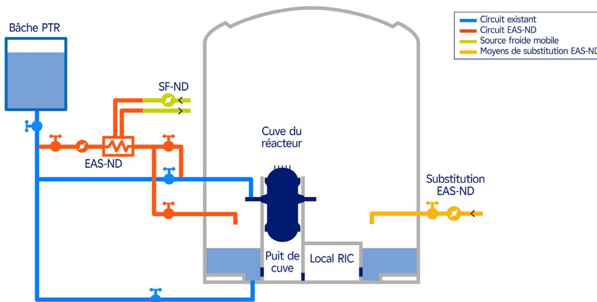
En complément et faisant suite à l'instruction de l'ASN, EDF va procéder à la mise en œuvre d'une disposition supplémentaire permettant un appoint d'eau à moyen/long terme dans le fond de l'enceinte par des moyens mobiles, afin de maintenir le refroidissement du corium en cas d'arrêt ou d'indisponibilité de l'EAS-ND
