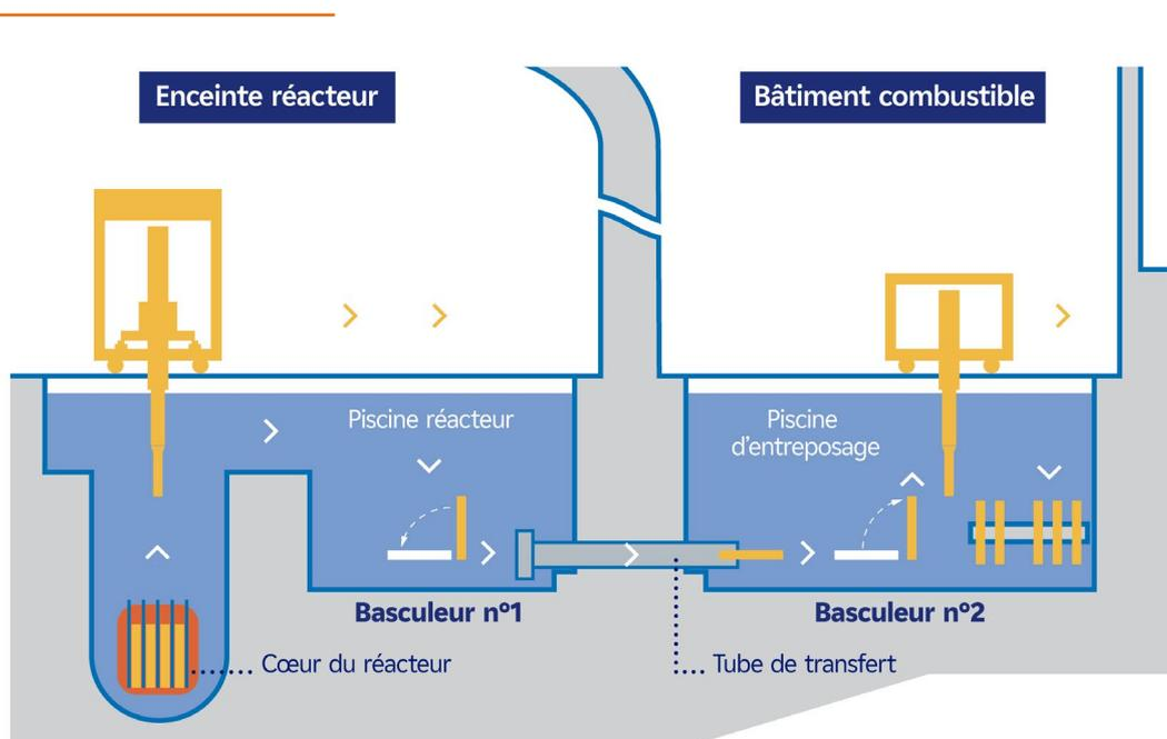
illustration 1. principe du transfert d'un assemblage de combustible du cœur du réacteur vers la piscine d'entreposage)
