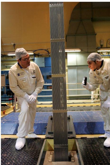
Figure 4. Assemblage de combustible (Copyright EDF / SAUTERAU Frédéric)
