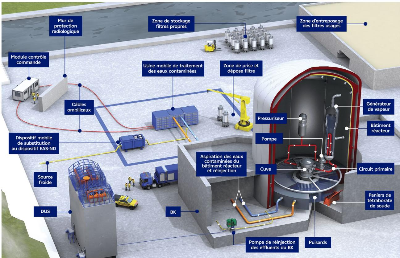
Figure 11. Illustration des dispositions « Lignes fixes pour le traitement des eaux contaminées dans le bâtiment réacteur et modules mobiles de traitement des eaux contaminées », « Mise en œuvre d'une ligne d'injection et d'un dispositif mobile de substitution au dispositif EAS-ND », « Réinjection des effluents du bâtiment combustible dans le bâtiment réacteur », « Mise en place de paniers de tétraborate de sodium décahydraté dans les puisards du bâtiment réacteur »
