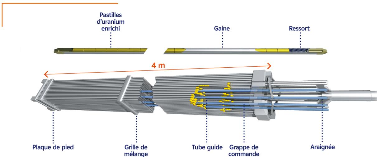
Figure 3. Schéma d'un crayon combustible et d'un assemblage de combustible
