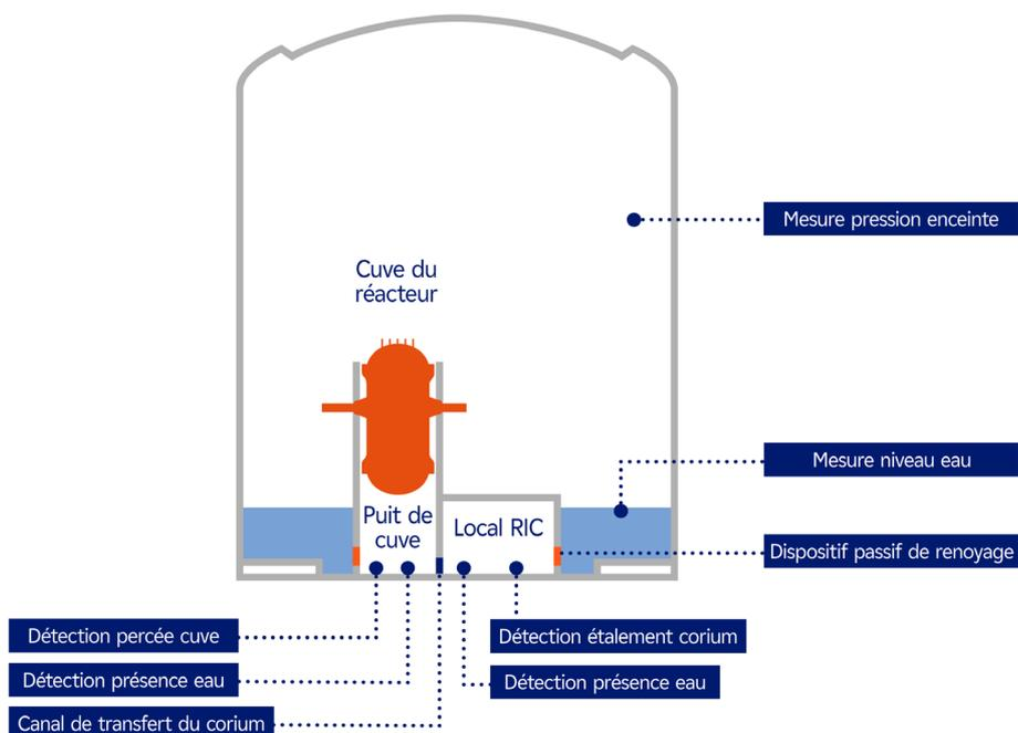
Figure 12. Illustration de la mesure de niveau d'eau dans les puisards du bâtiment réacteur et de la détection de l'étalement du corium dans le local d'instrumentation du cœur (RIC)
