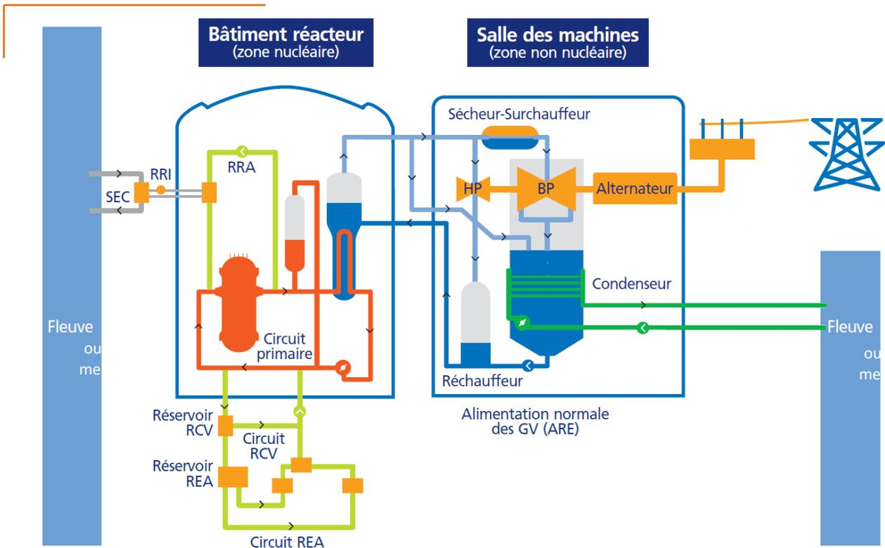
Figure 25. Réacteur en fonctionnement normal : principaux circuits
