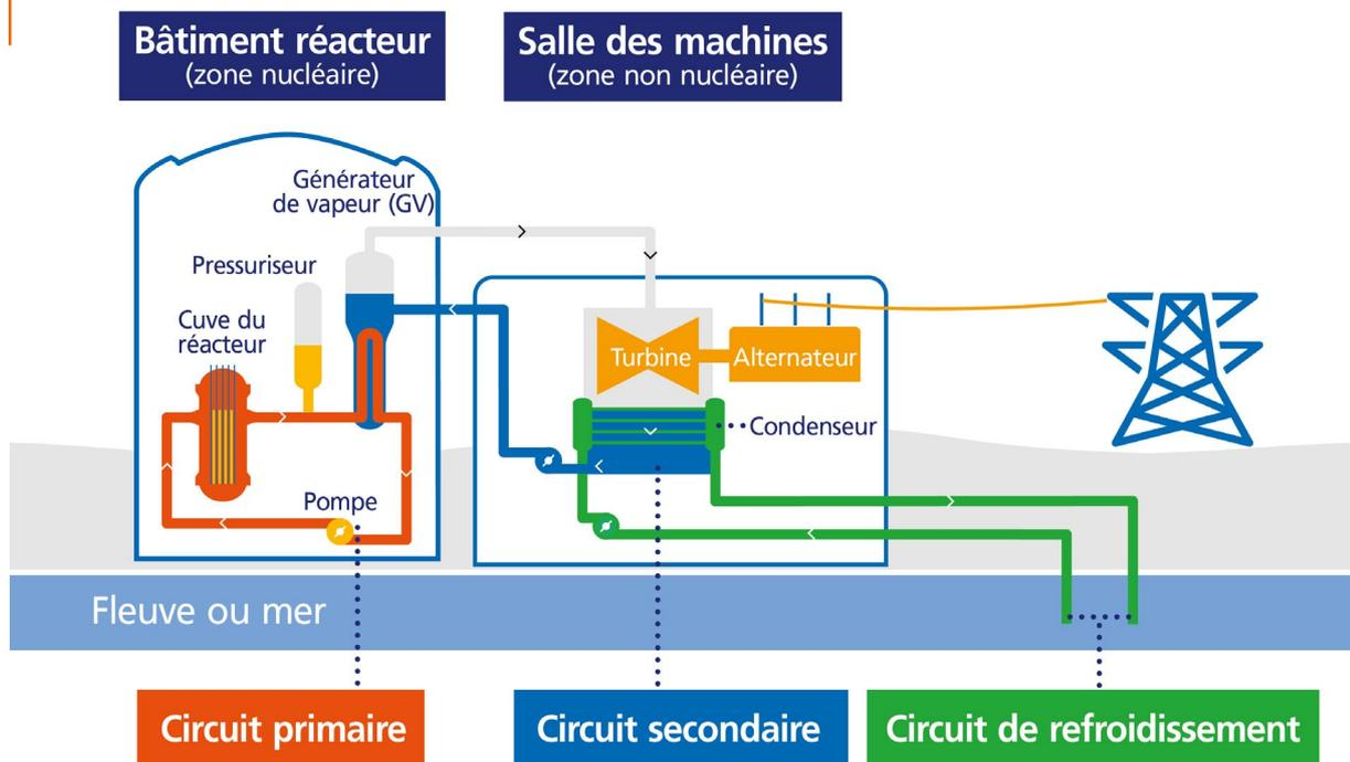
Figure 24. Principes de fonctionnement d'une centrale nucléaire
