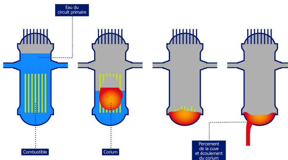
Dans cette situation, les deux premières barrières de confinement sont endommagées et l'objectif de sûreté est alors de préserver l'étanchéité de la 3<sup>e</sup> barrière, l'enceinte de confinement, pour éviter la dispersion de produits radioactifs dans l'environnement.
