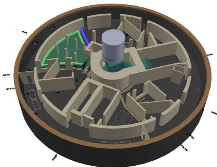
Avec ces dispositions, les études effectuées montrent pour le réacteur n°1 de la centrale du Blayais que l'érosion du béton par le corium restera limitée au regard de l'épaisseur du radier du bâtiment réacteur.
