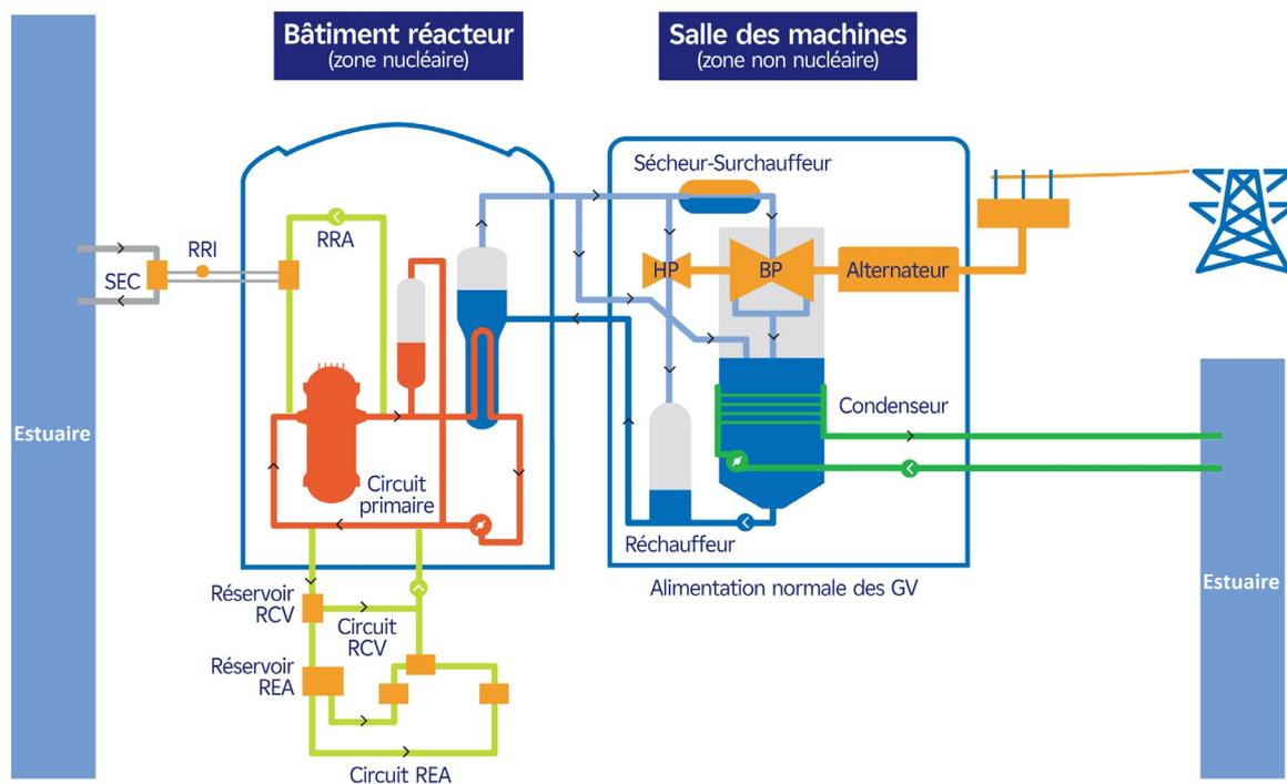
Figure 1. Réacteur en fonctionnement normal : principaux circuits
