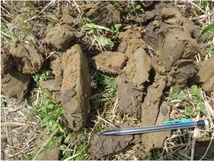
Figure 5 : Sondages ST6 et ST7. Argile à argile sableuse lourde à caractère verticale marqué
