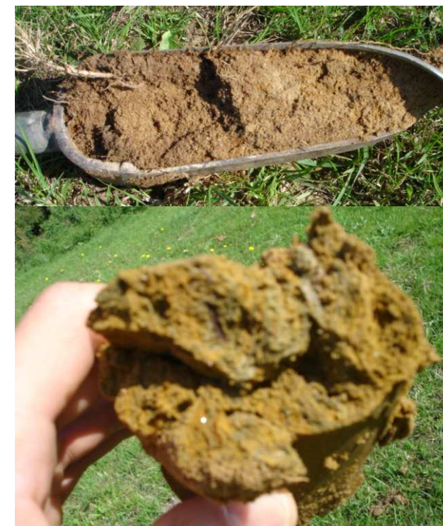
Diagram of a soil profile with three horizons: Horizon 0-20 cm: Terre végétale brune très sableuse. Présence de traces de couleur rouille. Horizon 20-40 cm: Argile sableuse ocre. Présence de traces de couleur rouille. Horizon 40-60 cm: Argile peu sableuse. Présence de traces de couleur rouille. Présence de quelques traces de réduction.
