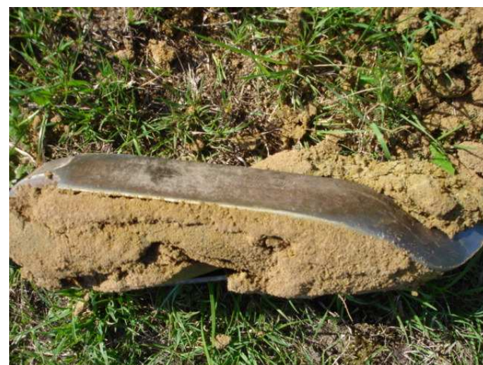
0 Terre végétale brune très sableuse Présence de traces de couleur rouille 30 Argile sableuse ocre Présence de traces de couleur rouille 70 Horizon induré 50 Argile peu sableuse Présence de traces de couleur rouille Présence de quelques traces de réduction 70
