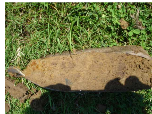
0 Terre végétale brune très sableuse Présence de traces de couleur rouille 20 Argile peu sableuse Présence de traces de couleur rouille Présence de quelques traces de réduction 60
