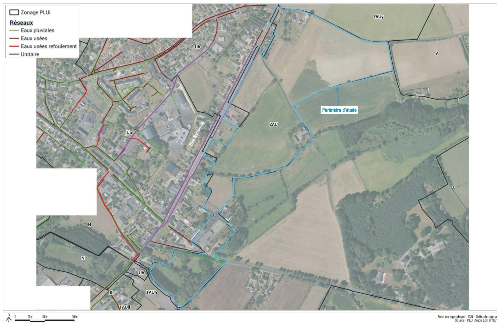
Figure 69 : Localisation des réseaux d'assainissement et eaux pluviales
