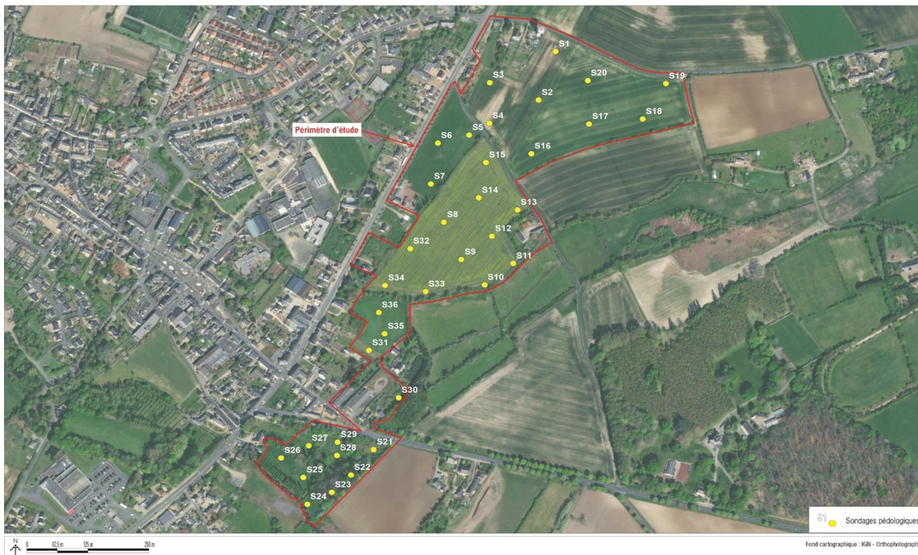
Figure 30 : Localisation des points de sondages pédologiques réalisés
