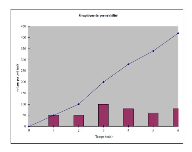
La conductivité hydraulique (ou permé abilité) d'un sol saturé est évaluée avec un infiltromètre SDEC à charge constante. Cet appareil est placé dans un trou réalisé à la tarrière manuelle de 150 mm. Il est posé à la profondeur ou l'on souhaite connaître l'infiltration. La mesure du volume infiltré est ensuite réalisé après plus de 4 heures de saturation du sol en place.
