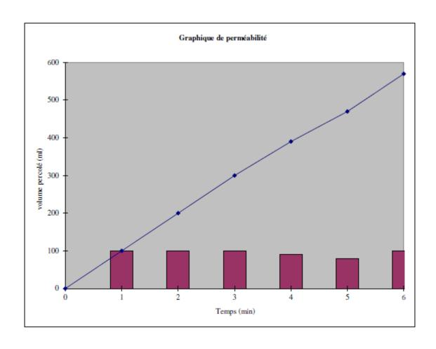
La conductivité hydraulique (ou perméabilité) d'un sol saturé est évaluée avec un infiltromètre SDEC à charge constante. Cet appareil est placé dans un trou réalisé à la tarrière manuelle de 150 mm. Il est posé à la profondeur ou l'on souhaite connaître l'infiltration. La mesure du volume infiltré est ensuite réalisé après plus de 4 heures de saturation du sol en place.
