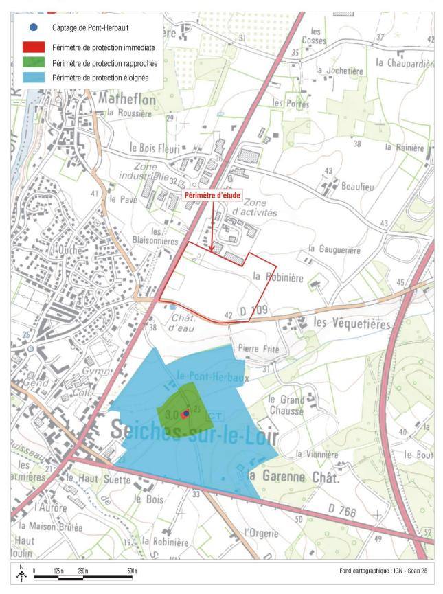
Figure 10 : Captage AEP de Pont-Herbaux et périmètres des protection
