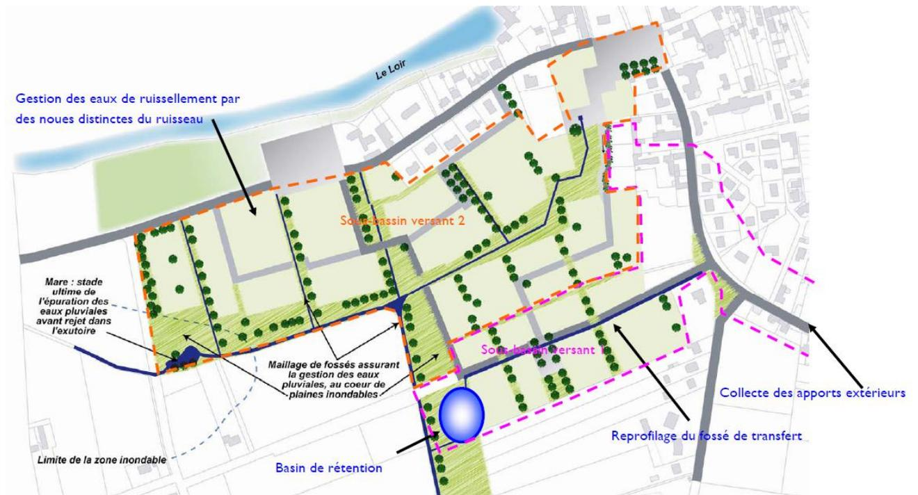
Figure 6 : Principes d'assainissement des eaux pluviales
