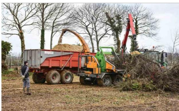
*La filière bois-énergie a pu être relancée grâce aux innovations de la mécanisation pour le déchetage du bois issu de l'entretien des haies*
