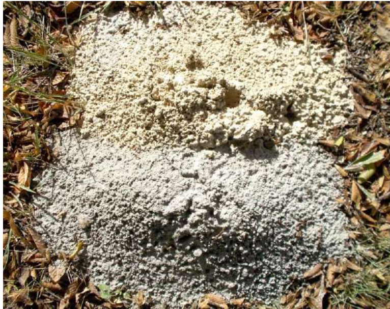
Passage de craie bleu à glauconie vers 50 m de profondeur
