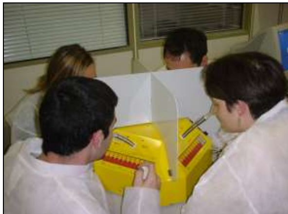
Photographie 2 : Séance de tests olfactométriques conforme à la norme AFNOR NF EN 13725
