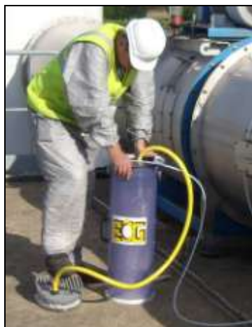
Photographie 1 : Système de prélèvement de type « caisson poumon »
