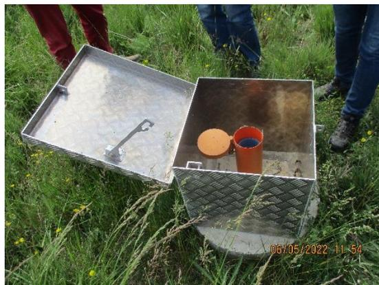
La dalle du piézomètre devra être agrandie pour atteindre 1 m de rayon minimum, et la tête devra être réhaussée à 50cm au-dessus des PHEC sur site soit à 61 mNGF.
