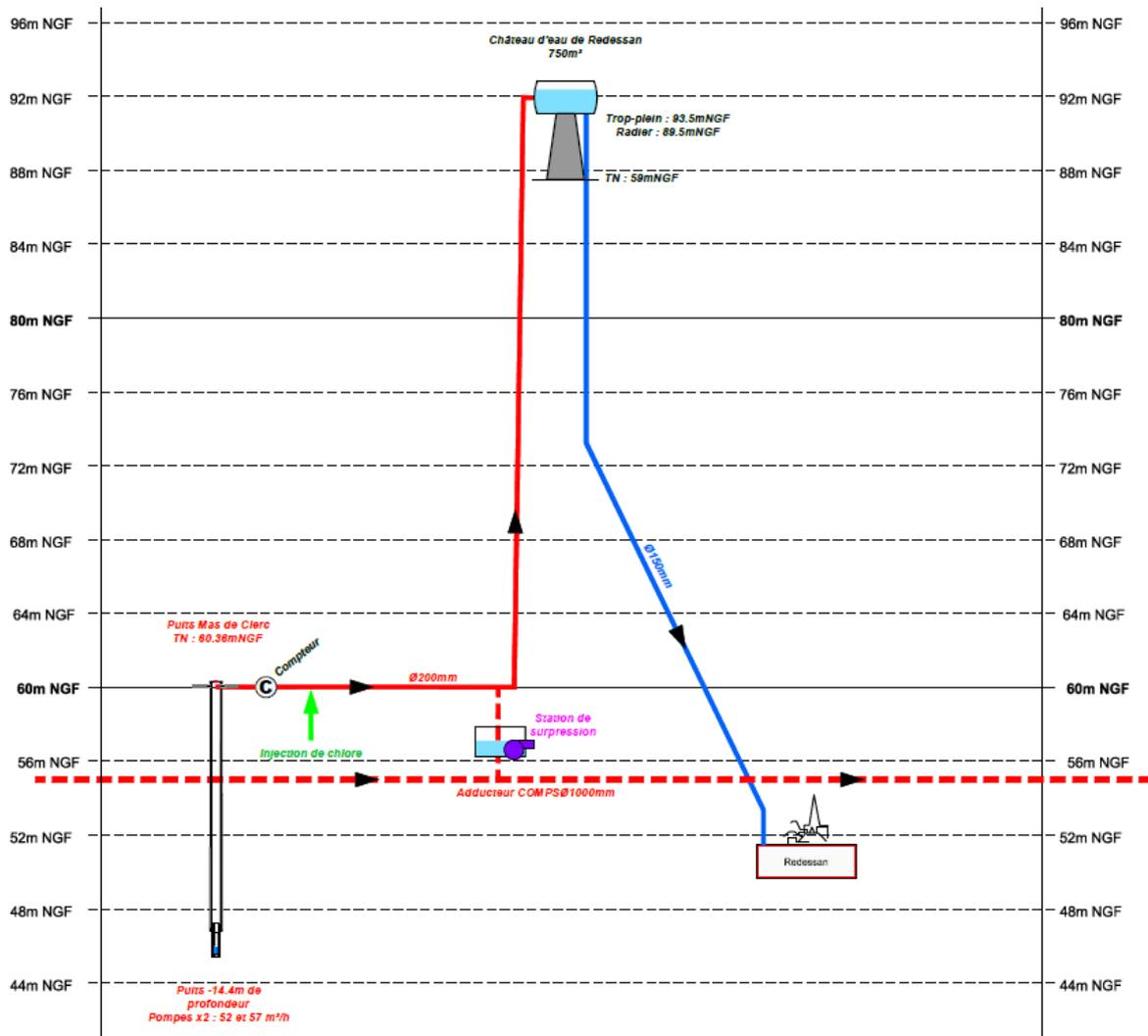
Figure 4 : Synoptique d'alimentation en eau potable de la commune de Redessan
