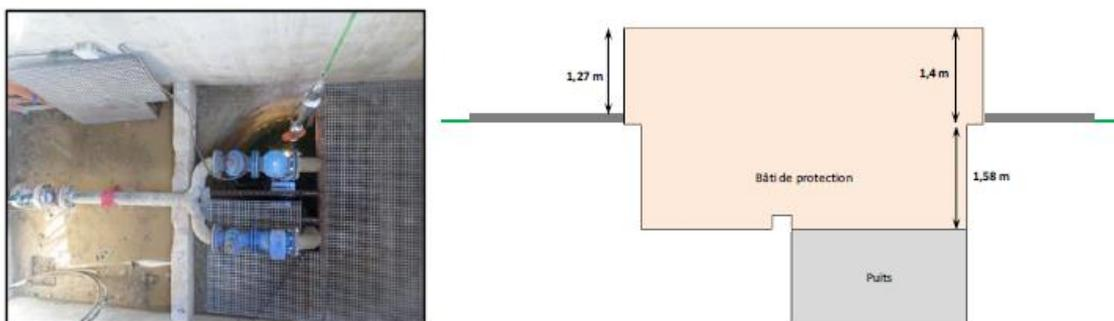
Vue de l'intérieur et schéma de la tête du puits (Idées Eaux, diagnostic par inspection télévisuelle du puits du Mas de Clerc (octobre 2017))
