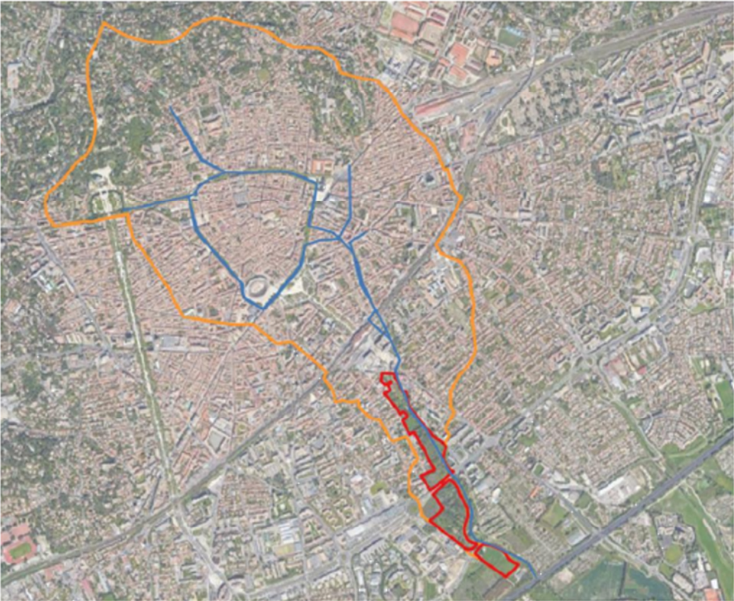
FIGURE 3 : DEFINITION DU BASSIN VERSANT INTERCEPTE
