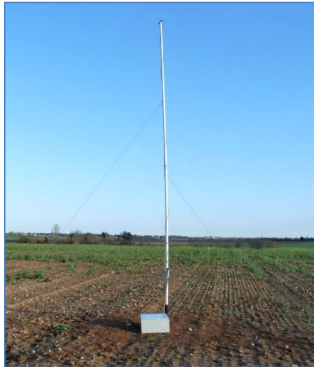
Caisson du SM3BAT relié à la perche de 6 m, lors du suivi en continu à basse altitude – A. Liger, Ecosphère
