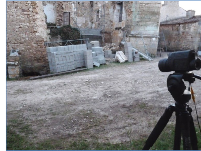
Observation de l'entrée de la cave du château de Balanzac, à l'aide d'une caméra thermique sur trépied – A. Liger, Ecosphère
