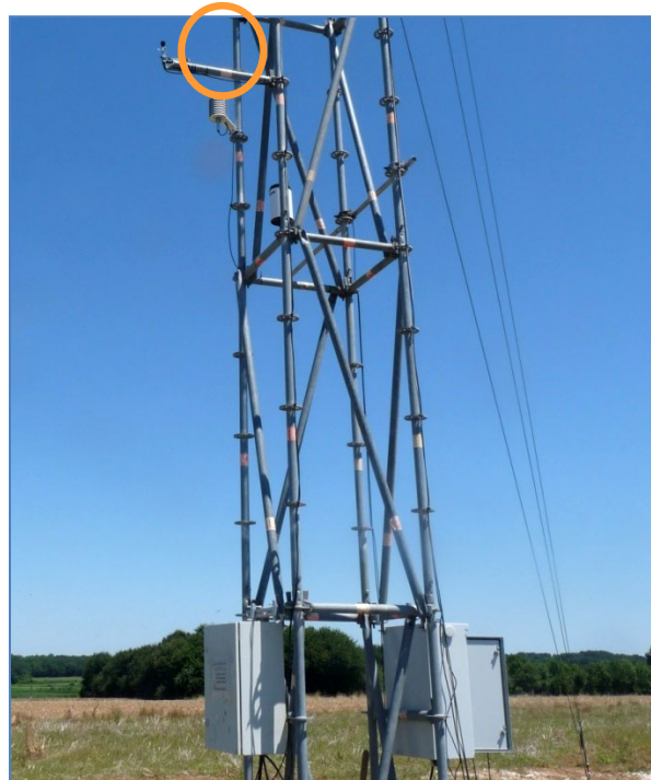
Vue sur un des appareils de mesure (cercle orange) et les caissons abritant le SM3 d'une part, le système d'enregistrement des données météo (en bas à droite) d'autre part – A. Liger, Ecosphère
