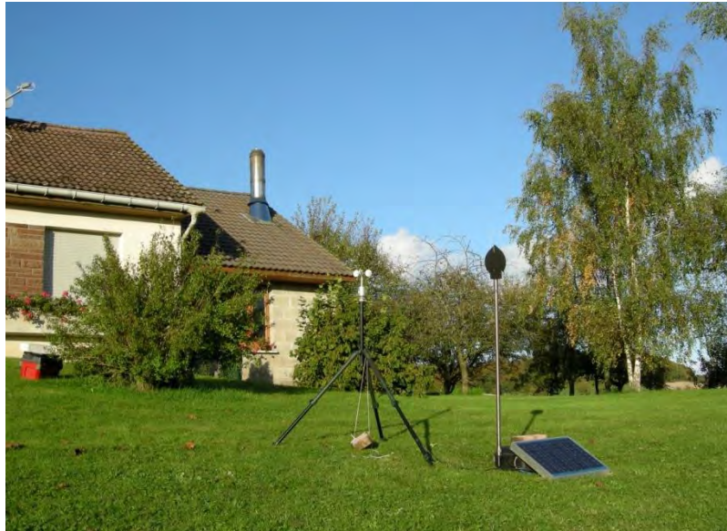
Figure 11 : Photographie d'un sonomètre en cours d'utilisation
